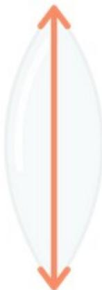
Une lentille convergente est symbolisée par 2 flèches orientées vers l'extérieur.
